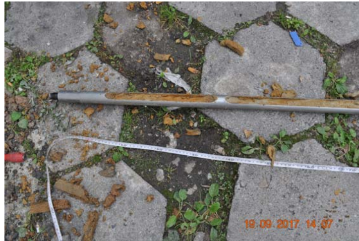
Próba z profilu geotechnicznego 03, głębokość 3,0-3,70m.
