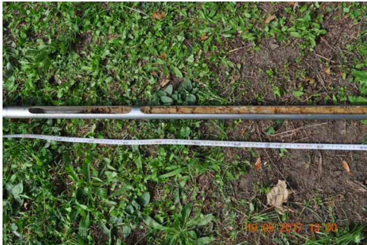
Próba z profilu geotechnicznego 02, głębokość 3,0 -3,9 m p.p.t.
